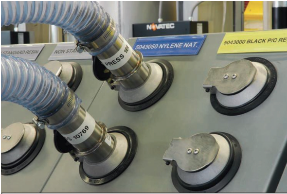
Los gabinetes inclinados proporcionan conexiones fáciles al alcance con fuentes y destinos claramente marcados.
